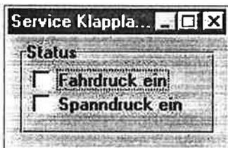
Bei angekreuztem "Fahrdruck ein" wird im Systemdruck der programmierte Fahrdruck ausgegeben.
