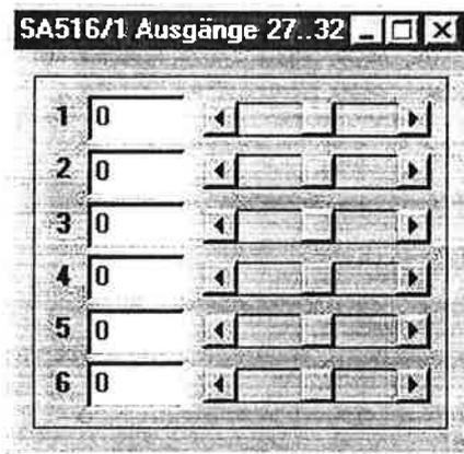
Anzeige der Inkrementalen Werte der Bipolaren Analogausgänge des Moduls SA516 / 1 (2,3). Wertebereich von -2048 bis +2047, wobei 0 (ca.) dem elektrischen Wert 0 entspricht. Diese Anzeige ist für alle 3 SA516 Module vorhanden.
